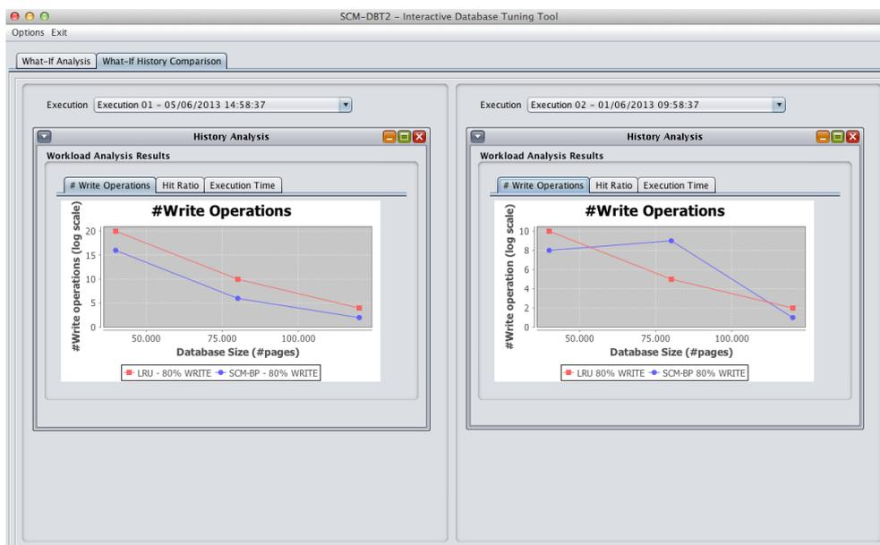
Figura 3. *SCM-BT<sup>2</sup>* Interface - Comparando a quantidade de escritas geradas pelas políticas de *buffer*.
